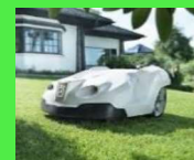
Robot tondeuse : capteurs qui identifient les limites du terrain, la hauteur de l'herbe, ordinateur qui transmet les informations aux actionneurs (roues et lame)
