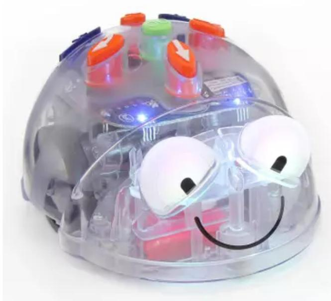
Bluebot est un robot pédagogique qui peut être programmé à l'aide des boutons placés sur le dessus ou avec une "barre de programmation" et des "jetons" en plastique.
